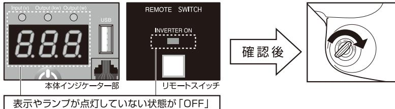
3. 本製品の電源スイッチを押して「ON」の状態にしてください。インジケーターが点灯し現在の入力電圧と消費電力を交互に表示します。
