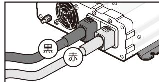
5. 製品側の接続を完了・確認してから、反対側の丸型端子を+端子へ、-端子へ接続します。
