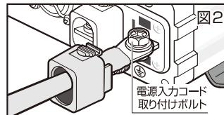
3. 電源入力端子に電源入力コードを取り付けボルトにてしっかりと固定します。(図2)
