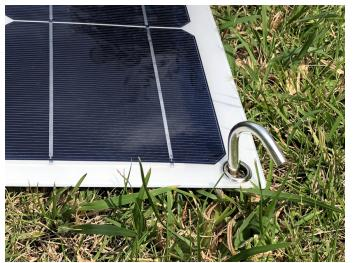
※注意 太陽電池パネル全面に太陽光が当たるように、位置、向き、角度を調節してください。パネルの一部が陰になると、発電量が大きく低下します。
